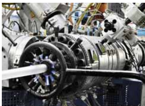
Rysunek. Ekstruder do wytłaczania rur.
