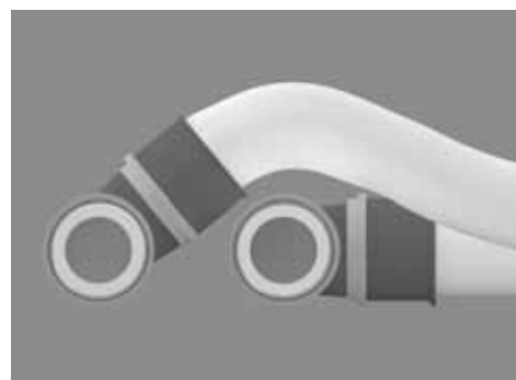
Rysunki. Przykład przejścia nad rurą.
